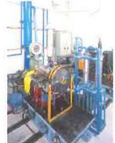
柴油发动机耐久试验 การทดสอบความทนทานเครื่องยนต์ดีเซล
